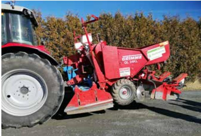
Die am Hubwerk getragene Legemaschine ist mit Kreiselegge, Granulatstreuer, Dammformblechen und Erosionsstopp ausgestattet. Der Erosionsstopp erzeugt Zwischendämme und erhöht dadurch das Wasserhaltevermögen. In den erzeugten Mulden kann so das Wasser bei Starkregen an Ort und Stelle versickern und wird vom Abrinnen gehindert.
