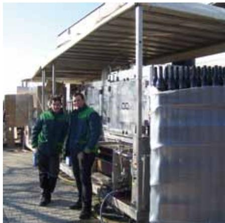
3 mobile Füll- und Etikettieranlagen, 1 Crossflow-Filteranlage und 2 Kieselgur-Filteranlagen.
