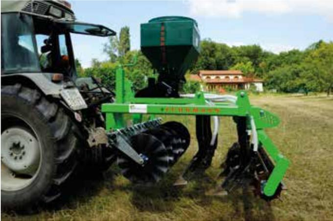
Im Weinbau ist in erster Linie durch das neue ÖPUL die Nachfrage nach Technik für aktive Anlegung von Begrünung rasch gestiegen. Ein pneumatisches Direktsaatgerät speziell für den Begrünungsanbau und für Begrünungs-Revitalisierung im Weingarten kombiniert mit einer Kreiselegge zur mechanischen Bodenbearbeitung und Saatbeetvorbereitung bietet hier die praktische Lösung.
