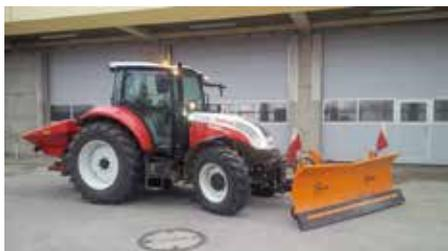
40km/h Ausführung; 4 dw. Steuergeräte, 2 davon elektro-hydraulisch; Druckluftanlage; Einhandbedienung „Joystick“; Kabinenfederung; Klimaanlage; HAUER Fronthydraulik; 2 Zusatzleitungen, 1 x 3- und 2 x 7-polige Steckdose vorne; Unterzug (bis zur Hinterachse) montiert
