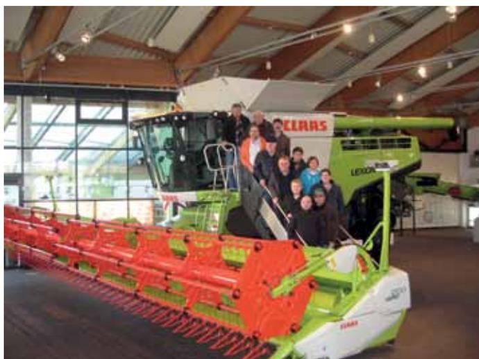
Claas Lexion 780 mit Raupenfahrwerk und 12 m Schneidwerksbreite
