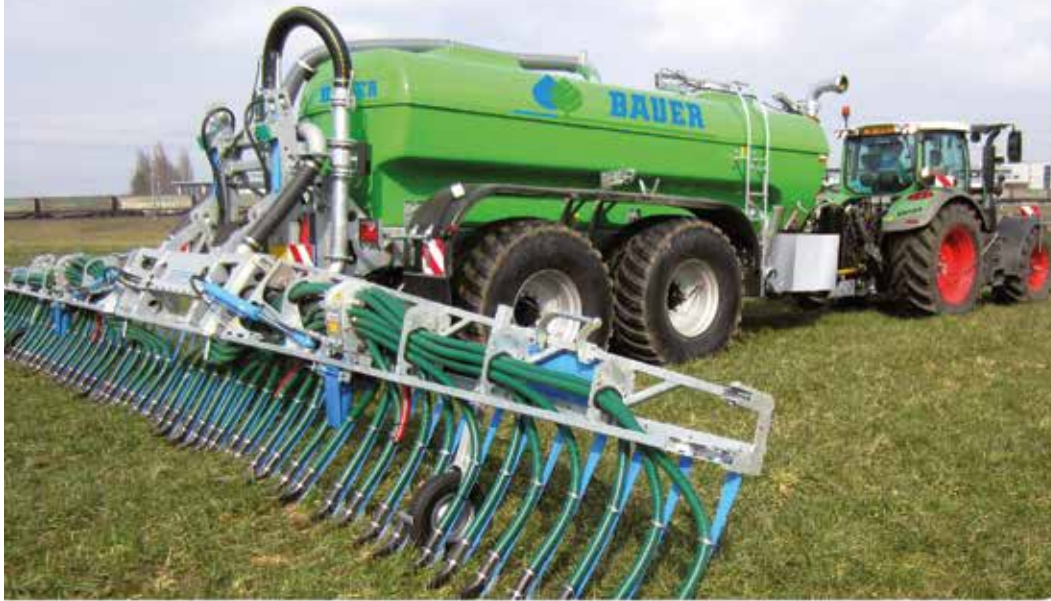
Polyestertankwagen mit Schleppschlauchverteiler, von 10.500 bis 24.000 Liter
