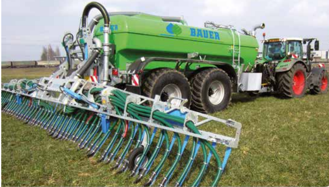
Polyestertankwagen mit Schlepschlauchverteiler, von 10.500 bis 24.000 Liter
