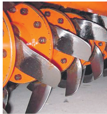
DURCH DIE S-FÖRMIGEN Messer der Umkehrrotoregge besteht keine Gefahr der Pflugsohlenbildung. Sie arbeitet flacher und legt Steine und Unkrautsamen im Unterboden ab.
