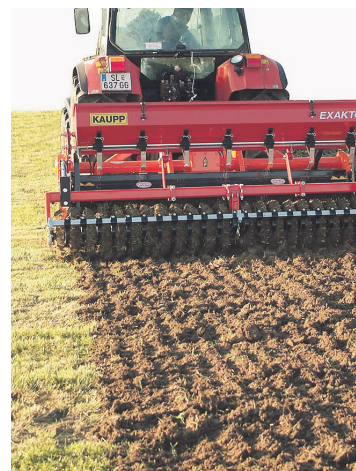
DIE UMKEHRROTOREGGE arbeitet nur in der obersten Humusschicht und bringt dadurch keine tote Erde (Steine) nach oben.
