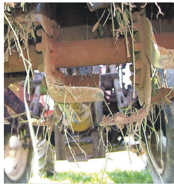
DIE ACKERFRÄSE besitzt L-förmige Werkzeuge und arbeitet tiefer als die Rotoregge. Der Boden muss gut abgetrocknet sein, da sonst die Pflugsohle verdichtet wird.
