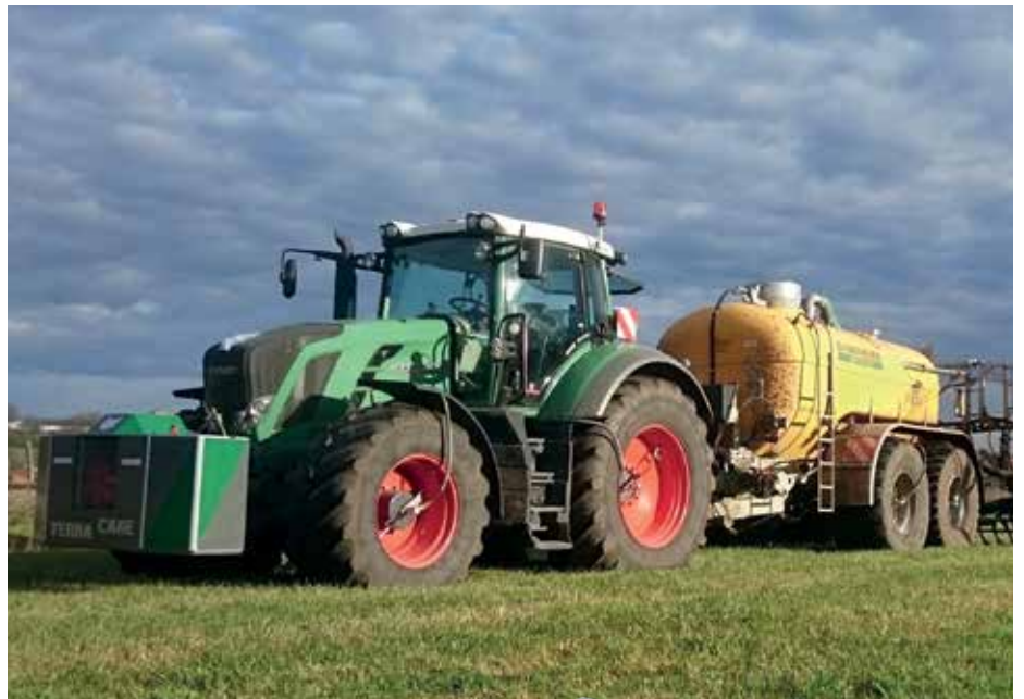
Traktor und Gülle-Anhänger mit Reifendruckregelanlage
