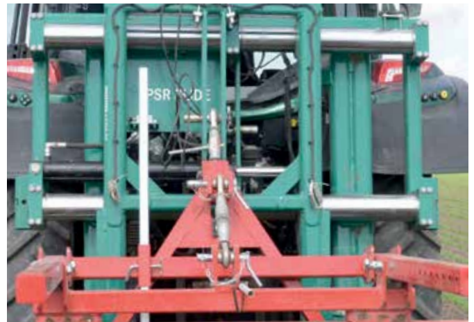
im linken Bild die Displays der Steuereinheiten, im rechten Bild der elektrohydraulische Verschieberahmen
