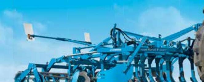
Mit dem optionalen Zinken-Schnellwechselsystem kann der Karat werkzeuglos an unterschiedlichste Einsatzbedingungen angepasst werden.
