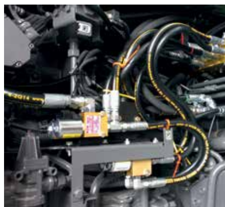
Direkter Eingriff in die Lenkhydraulik
