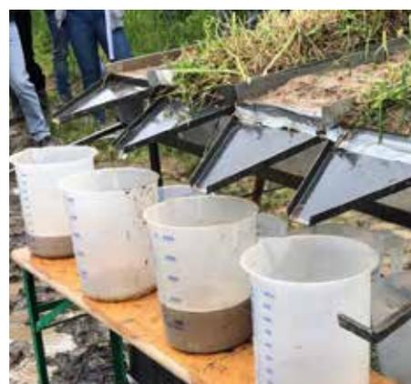
Praxisnahe Versuchsanordnung - Wasserspeicherung, verschiedene Bodenprofile
