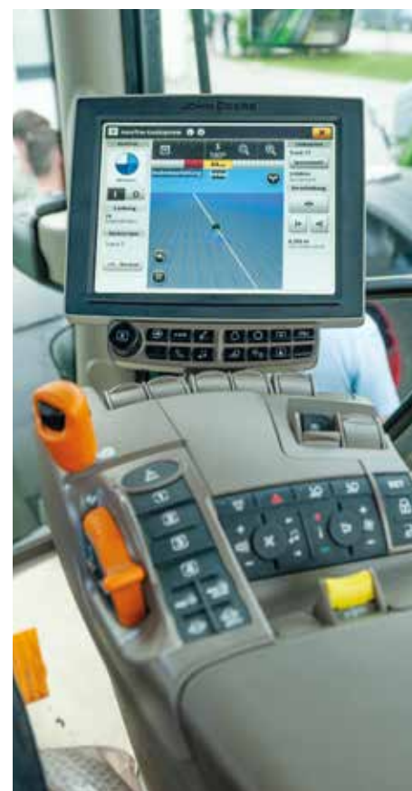
Section Control bei Pflanzenschutzspritze (Bearbeitungsgrenze bekannt)
