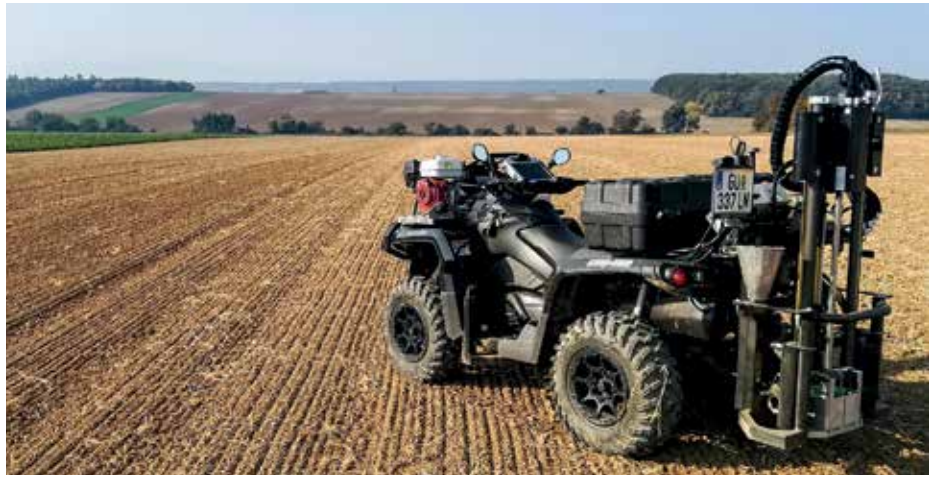
Anschließende Beprobung mit dem Nährstoffmanagement-Quad der Maschinenring Agrar Concept GmbH in den kartierten Zonen. Die Bodenanalyse der Referenzpunkte dient als Grundlage für die Zonenbewertung.
