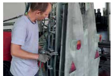
Einstellen der Luftleitbleche an der Pflanzenschutzspritze
