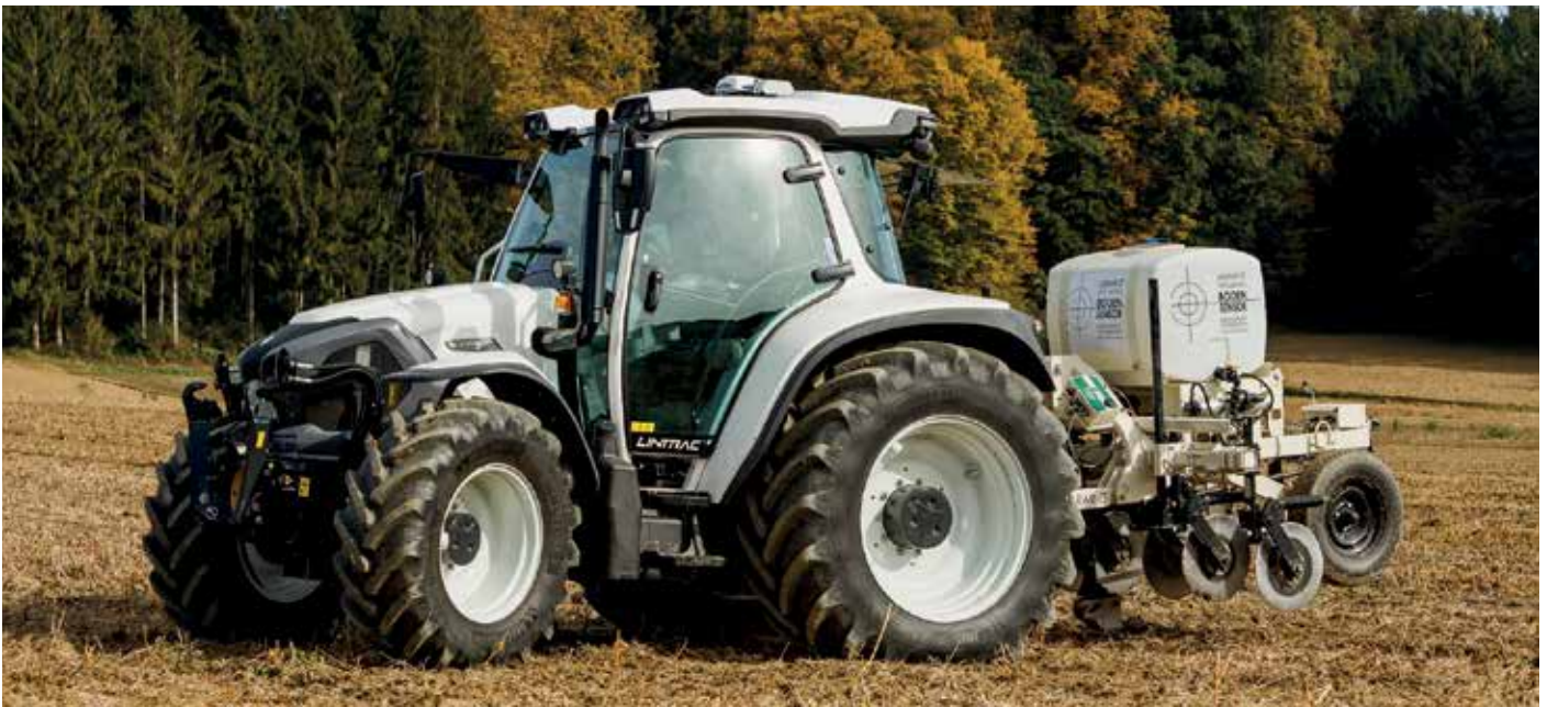
Modernste Technik im Einsatz: Traktor (am Bild ein Lindner Lintrac 110) mit RTK Lenksystem (TracLink Pilot mit Maschinenring Mobil RTK-Signal) und dem VERIS Bodensensor aus dem BUMIS*-Projekt.
