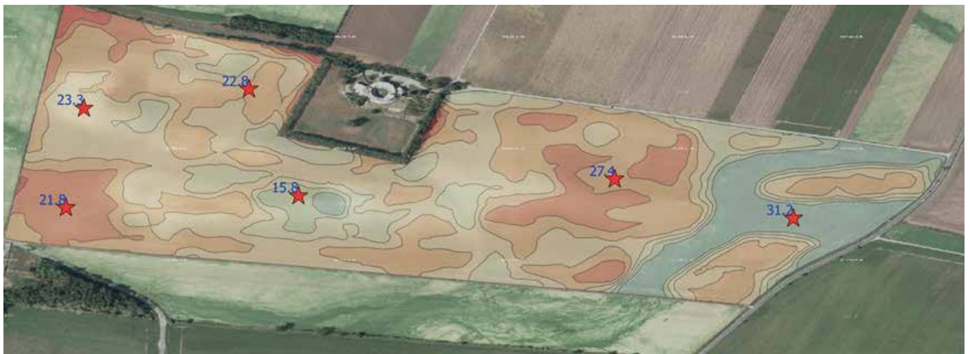
Bodenzonen mit Referenzpunkten aus dem BUMIS*-Projekt. Klar dargestellt: Die unterschiedlichen Teilflächen, hier die Bodenart auf Basis der Leitfähigkeit. Nun können nachfolgende Arbeitsschritte bodenspezifisch angepasst werden.
