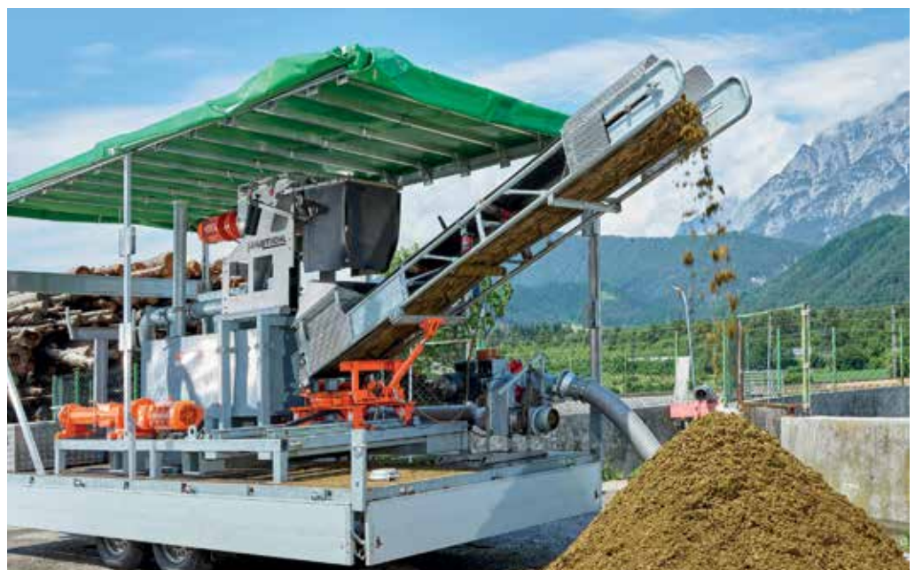
Mechanische Aufbereitung der Gülle mittels mobilem Gülleseparator
