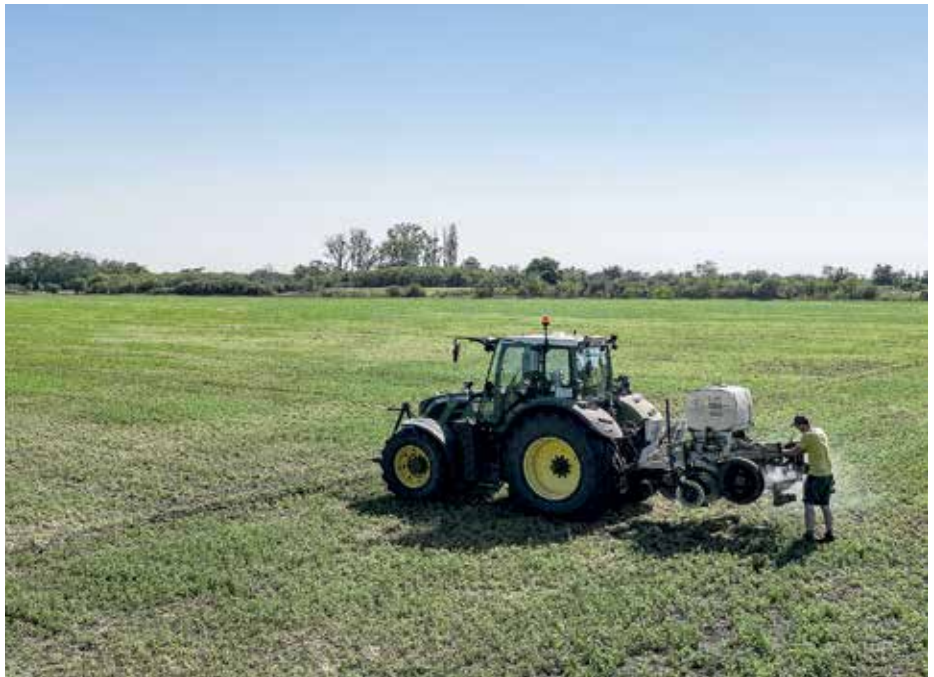
Abb. 4: Bodenzonierung mit dem VERIS-Bodensensor
