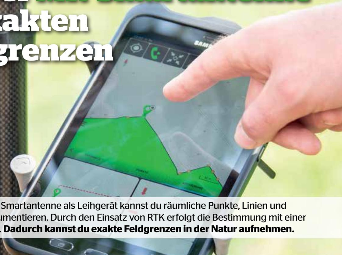
Mit unserer neuen GPS-RTK Smartantenne als Leihgerät kannst du räumliche Punkte, Linien und Polygone erfassen und dokumentieren. Durch den Einsatz von RTK erfolgt die Bestimmung mit einer Genauigkeit von ca. +/- 2 cm. **Dadurch kannst du exakte Feldgrenzen in der Natur aufnehmen.**
