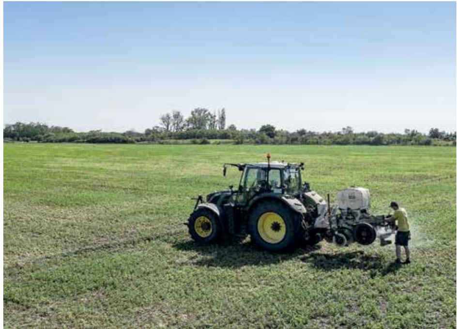
**Abb. 4: Bodenzonierung mit dem VERIS-Bodensensor**
