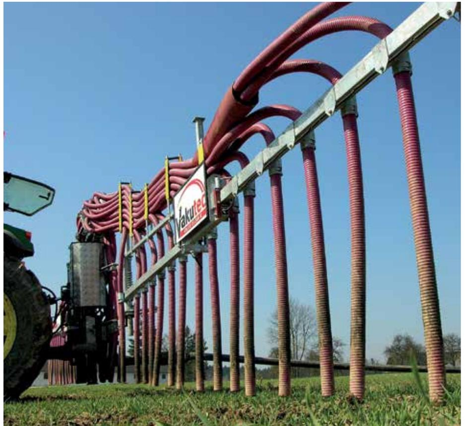
**Bodennahe Ausbringung: Gülleverschlauchung mit Schleppschlauchverteiler**
