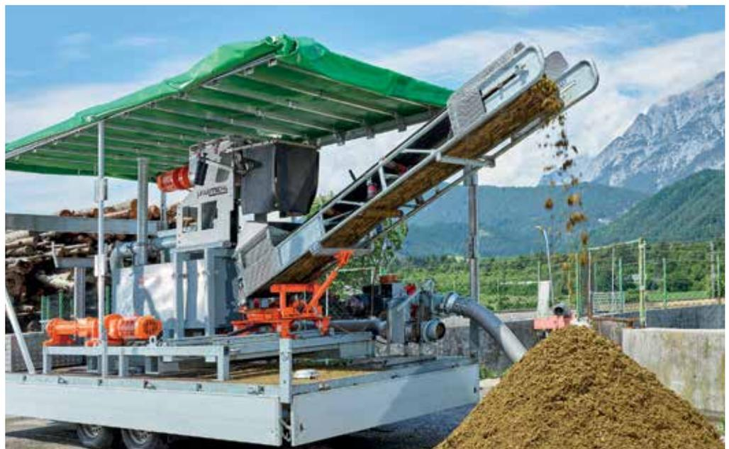
**Mechanische Aufbereitung der Gülle mittels mobilem Gülleseparator**
