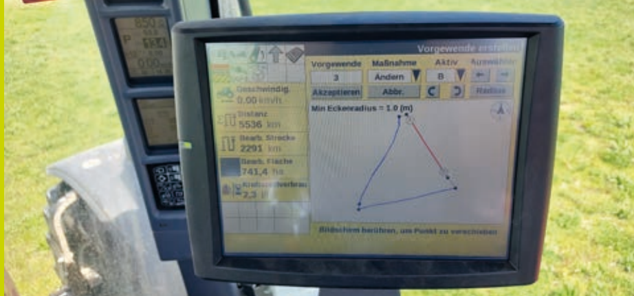
Abb. 4: AFS 700 Terminal - Automatisierte Fahrspurplanung anhand der Kontursegmente
