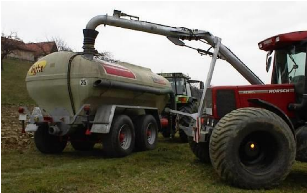
Abbildung 13: Direktes Überladen in Güllefass am Feld
