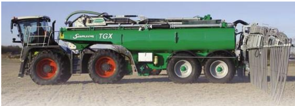
Abbildung 11: Gülle selbstfahrer mit Schleppschlauch-Ausbringung
