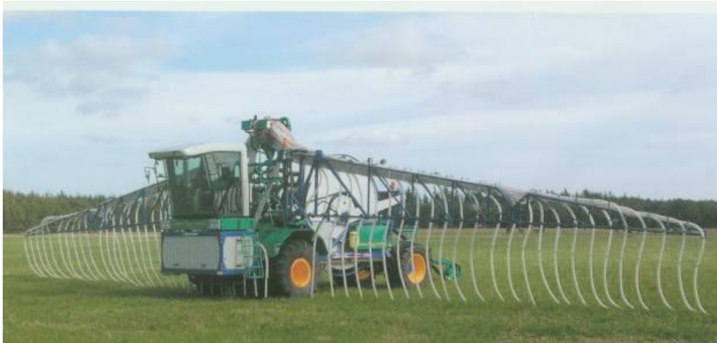
Abbildung 18: Selbstfahrer mit Gülleverschlauchung
