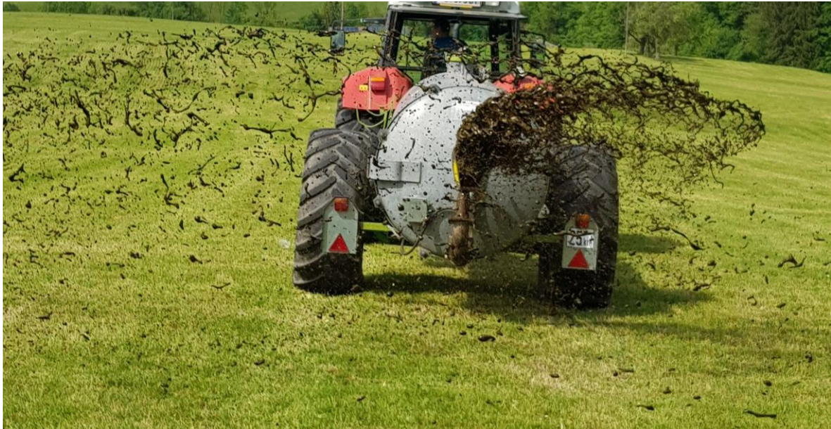
Abbildung 4: Möscha Schwenkverteiler bei der Ausbringung
