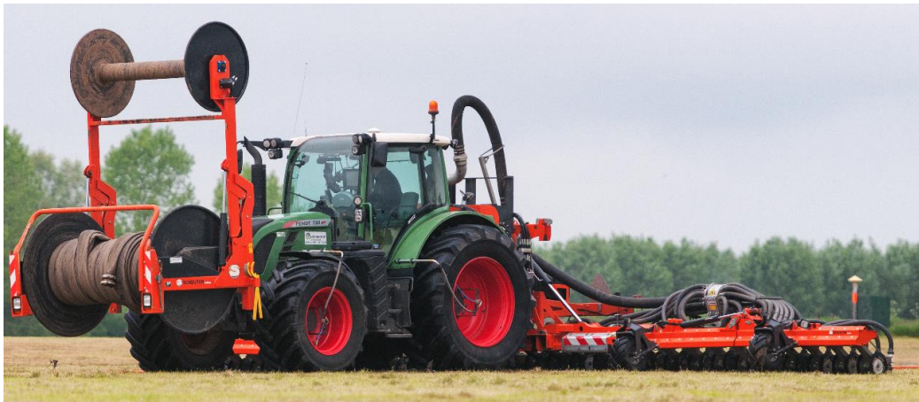
Abbildung 16: Schlitz-, Drillgerät mit Gülleverschlauchung
