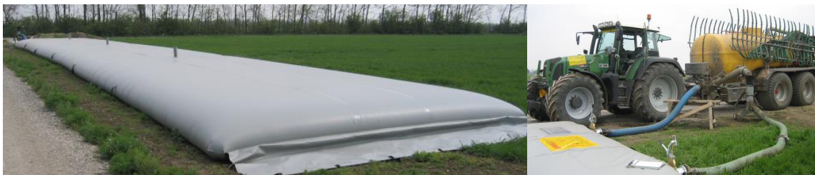
Abbildung 15: Mobiles Zwischenlager aus Polyestergerewebe
