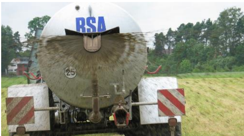
Abbildung 3: Schwanenhalsverteiler (Prallkopfverteiler) bei der Ausbringung
