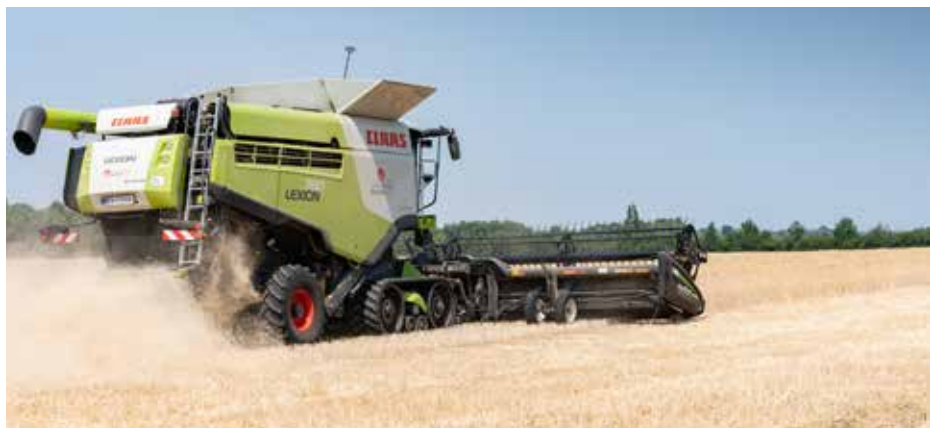
Claas Lexion 760 im Einsatz, bodenschonendes Raupenfahrwerk und 10,50m Schneidetisch
