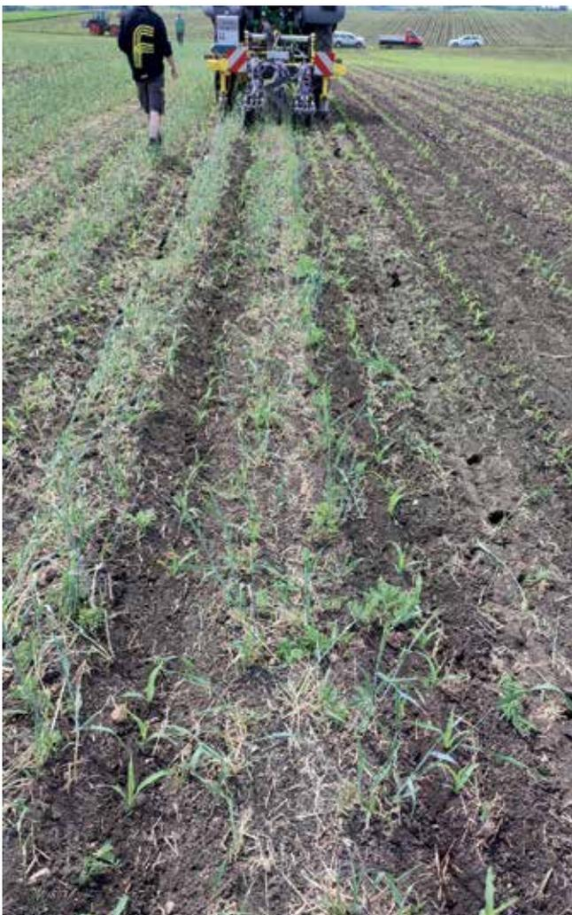
**Abb. 2: Prototyp einer In-Row Hacke der Fa. Feldklasse (DE) mit einem KI-gestützten Kamerasystem der Fa. Ullmann (CZ)**
