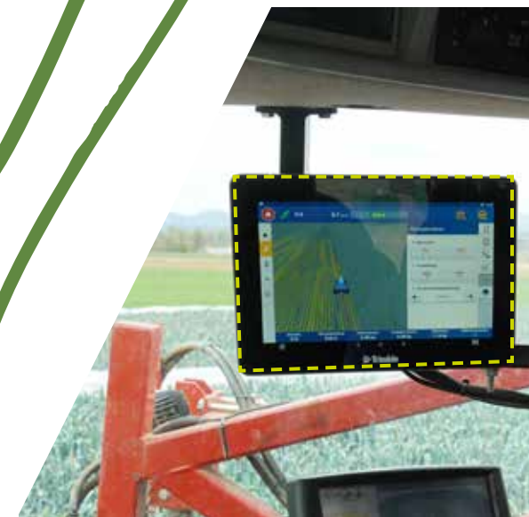
Das Setzen der Lauchpflanzen erfolgt RTK-gesteuert entlang digital geplanter und optimierter Spuren
