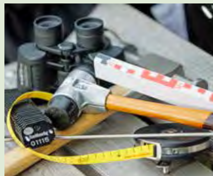
Spezialwerkzeug für eine Baumuntersuchung: Schonhammer, Sondierstab, Maßband, Fernglas und Messer
