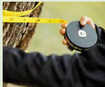
Der Umfang eines Baumes wird ebenso regelmäßig gemessen und vermerkt, um bspw. Kernfäule zu erkennen
