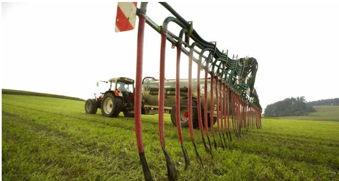
Bodennahe Gülleausbringung mittels Schleppschlauch
