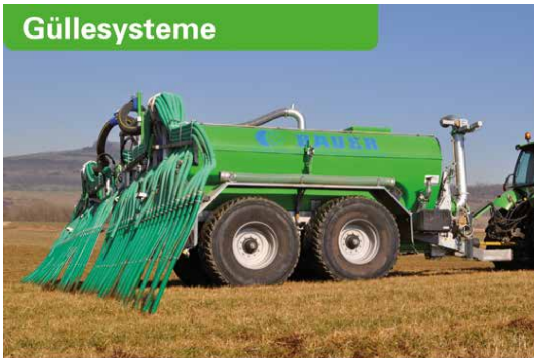
Polyestertankwagen mit Schleppschauchverteiler, von 10.500 bis 24.000 Liter
